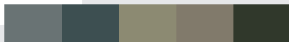
HKS 92 HKS 93 HKS 95 HKS 96 HKS 97 10C 0M 5Y 65K 25C 0M 10Y 80K 0C 0M 25Y 55K 0C 5M 20Y 60K 15C 0M 30Y 90K
